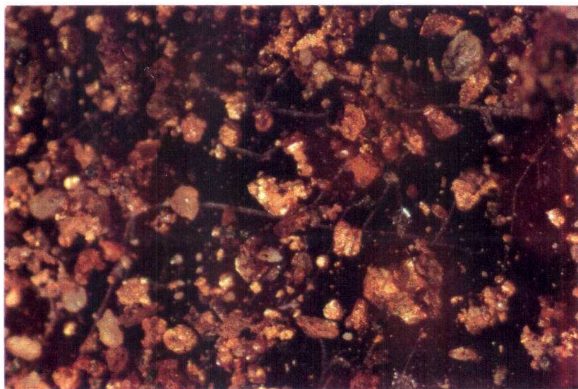
FOTO 9 (x 70). Concentrado de la matriz de las debritas de la calicata 27, granos en general redondeados y algunos idiomorfos con ta maños comprendidos entre 62 y 88 \mu .
